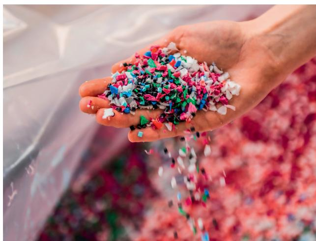
Die Verdränger von Unidome werden vollständig aus wiederverwertetem Polypropylen gespritzt. © GS Kunststofftechnik
